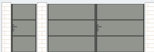
BASE 6 : TÔLES PLEINES 20/10 HORIZONTALES
