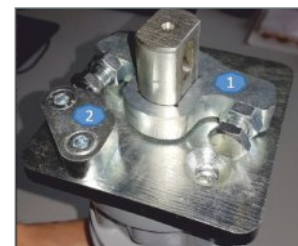
Système de butées mécaniques réglable en ouverture et fermeture (pièce 1 et 2)
