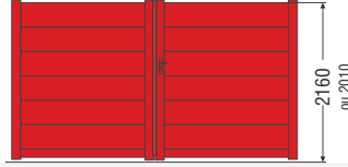
S2 - Lames de 300 avec 1 lame en partie basse de 100mm ou 150mm.
