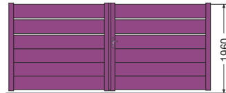
S3 Lames de 300 avec 2 ajours de 50mm entre 2 lames.
