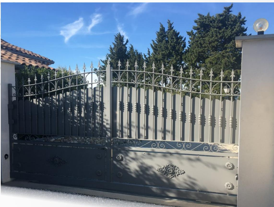
► Portail coulissant Gentilly avec profil à coulisse sur la traverse intermédiaire et potelet de guidage coté intérieur. Rangée de fers-de-lance n1 sur la traverse haute, double traverse en forme CDG, rangée de petite volutes verticales entre traverses. Une rangée de manchons n°1 sur les barreaux, cache-vue festonné suivant la lisse, double traverse intermédiaire, une rangée de volutes entre les traverses intermédiaires. Soubassement ajouré avec rosace et macarons.
