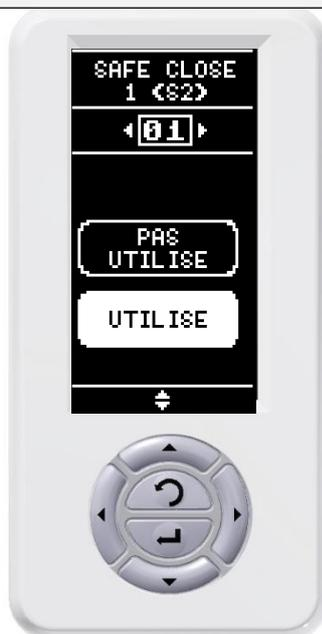
3° Configurer le test pour la sécurité pendant la fermeture du détecteur intérieur S2. Confirmer avec ENTER
