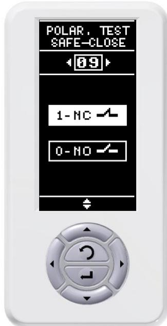
11° Configurer polarité du test contact sécurité pendant l'ouverture
