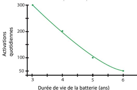
Remarque : l'autonomie de la batterie dépend de nombreux facteurs, notamment des activations quotidiennes, du temps utilisé par activation, de la portée du radar et des conditions extérieures.
