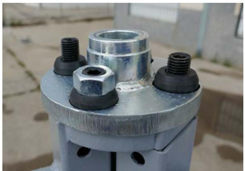
Glissez l'enjoliveur sur le rotor, attention il n'est pas symétrique, les vis de fixation doivent être en partie basse. Laissez-le en appui sur les bras temporairement.
