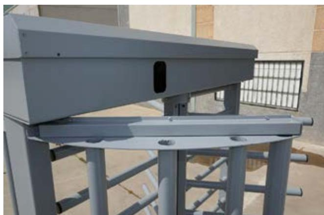
En partie basse du peigne fixe, 4 vis à tête Philips maintiennent la tôle d'accès au roulement inférieur du rotor: retirez ces vis et dégagez la tôle afin d'accéder au roulement..
