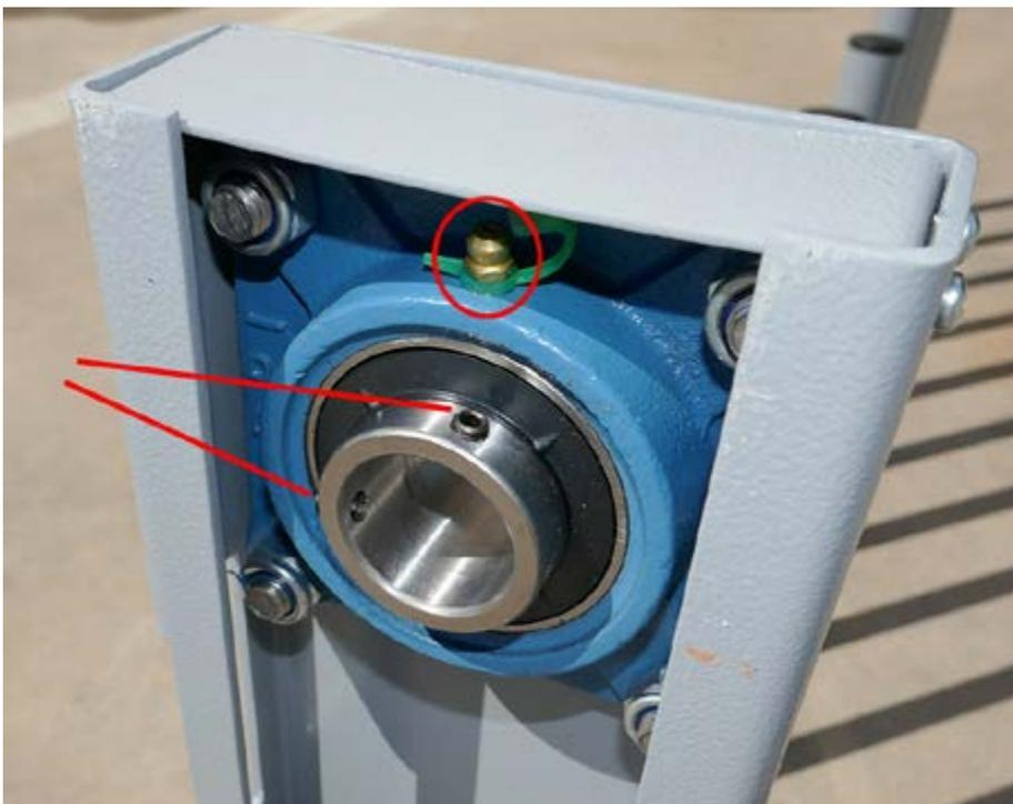
Serrez les deux vis Allen pointeau qui solidarisent la cage intérieure du roulement avec l'axe du rotor. Un graisseur permet à l'aide d'une pompe de graissage d'injecter de la graisse dans le roulement. Le roulement est graissé en usine mais suivant l'environnement d'installation un graissage est recommandé au minimum une fois par an.
