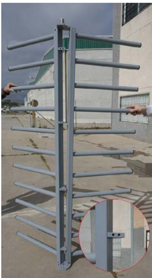
Prenez un des deux peignes esclaves et positionnez-le dans le peigne maître jusqu'en appui sur les triangles de fixation taraudés.
