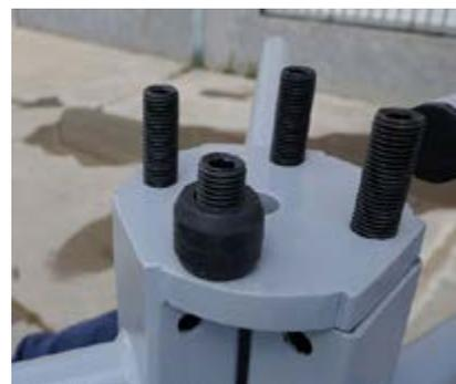
Placez la platine intermédiaire sur les silent-blocs. C'est cette platine qui relie le rotor au mécanisme en partie supérieure, son sens de montage est critique. L'encoche pour la clavette doit être positionnée telle que sur l'image, c'est à dire vers vous si vous avez le peigne fixe sur votre droite et le peigne maître du rotor sur votre gauche.
