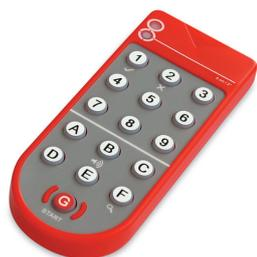
Le détecteur Hérakles 2E peut être configuré rapidement et aisément depuis le sol avec la télécommande bidirectionnelle RegloBeam 2. Chacun des paramètres peut être adapté à chaque situation.
