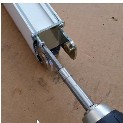
Capovolgere la barra 'A' e fissare la cerniera con le boccole con le due viti Ø4.8 x 25.
