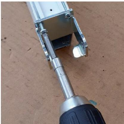
Capovolgere la barra 'B' e fissare la cerniera senza boccole con le due viti Ø4.8 x 25.
