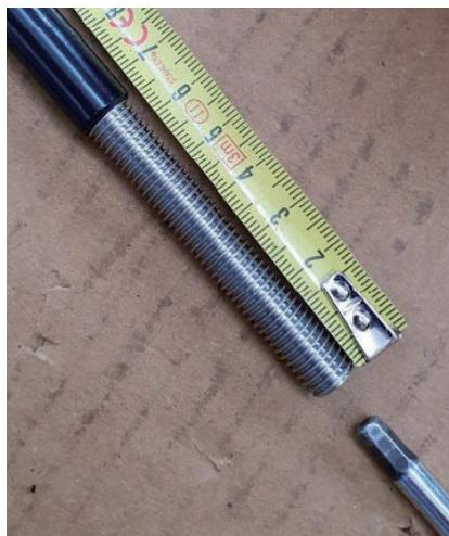
Con la chiave a brugola da 5mm , avvitare il grano M10x90 per 25mm, bloccandolo con LOCTITE 270 o equivalente.
