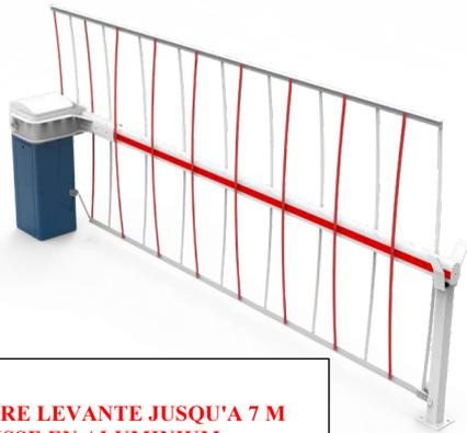
BARRIERE LEVANTE JUSQU'A 7 M LISSE EN ALUMINIUM 84 X 57 MM LISSE DE 4 M MAXI 135 X 93 MM LISSE DE 6,5 M MAXI 180 X 118 MM LISSE DE 7 M MAXI BARREAU DE DIAM 25 MM
