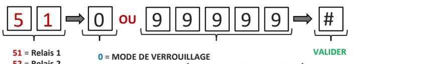
\* Par exemple : "515#" déclenchera le relais 1 pendant 5 secondes.
