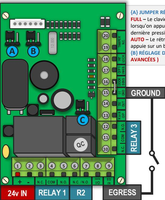
**{1,2} 24v 2Amp** = Bloc d'alimentation régulé (précâblé pour l'intérieur d'un système d'intercom AES)
