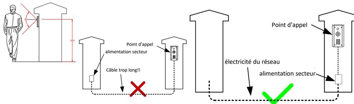
Montez l'interphone à la hauteur souhaitée pour les piétons ou les automobilistes. L'angle de la caméra est large, à 90 degrés, pour couvrir la plupart des scénarios.
