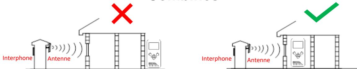
**Conseil :** Pour les installations à plus longue portée, placez le combiné près de l'avant de la propriété, près d'une fenêtre si possible. Les murs en béton peuvent réduire la portée à l'air libre de 400 mètres de 30 à 50 % par mur.
