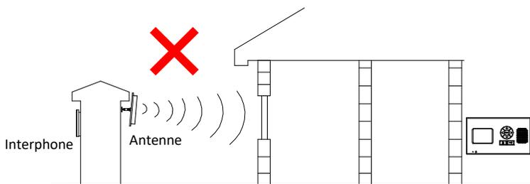
**Conseil :** Le moniteur 705 est doté d'une antenne/récepteur intégrée, il est préférable de l'utiliser pour les installations à courte portée.
