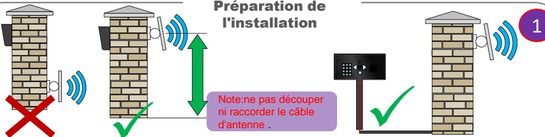
Montez l'antenne aussi haut que possible et loin des obstructions telles que les véhicules, les arbustes et les arbres pour maximiser la puissance du signal..
