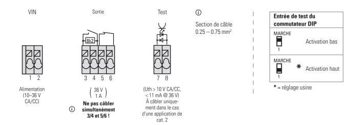
**Remarque :** En utilisant les sorties NF (5/6) en configuration Cat. 3, le câblage avec la commande doit être connecté en permanence et protégé contre les dommages externes selon l'EN ISO 13849-2 Tab.D.4 sinon la Cat. 2 s'applique et un signal de test est nécessaire.
