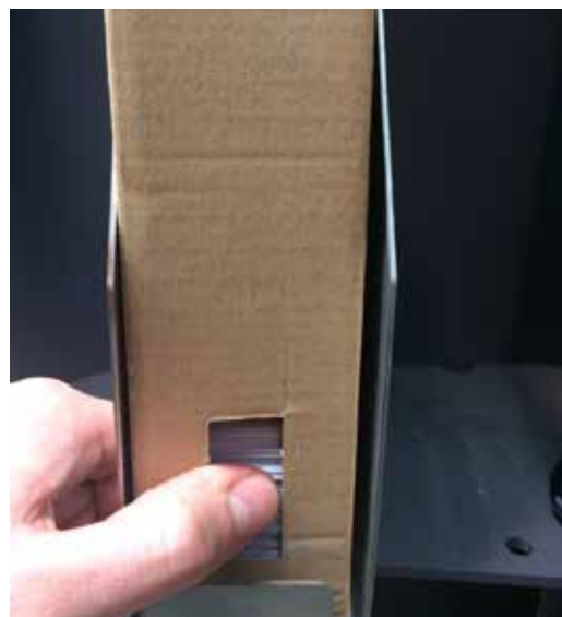
6 – Pousser les tickets hors de la fenêtre de l'emballage pour un bon fonctionnement de la cellule photoélectrique.
