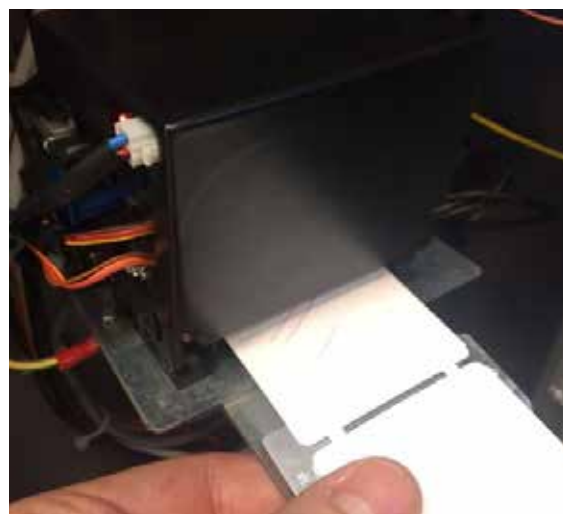
8 – Introduire les tickets dans la fente inférieure de l'imprimante. Le papier sera automatiquement chargé par l'imprimante : 3 tickets seront automatiquement imprimés avec les informations sur le dispositif. Pour contrôler le bon fonctionnement du système, imprimer au moins 3 tickets. Utiliser la fonction « Emit test ticket » (émission du ticket test) sur le menu de la carte Deneb (suivre les instructions du chapitre « MENU DENEb »).
