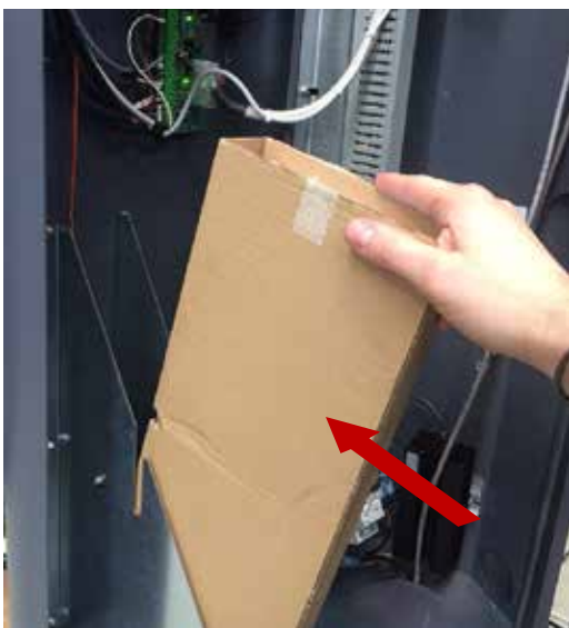
5 – Mettre le nouveau paquet de tickets dans le support prévu à cet effet sur la borne.
