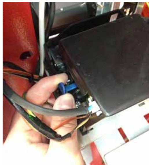
4 – Remettre le levier bleu de l'imprimante dans sa position d'origine, en le tirant vers l'extérieur avec deux déclics. L'opération correcte est signalée par une DEL verte.
