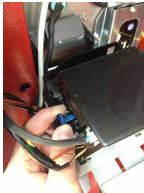
4 – Remettre le levier bleu de l'imprimante dans sa position d'origine, en le tirant vers l'extérieur avec deux déclics. L'opération correcte est signalée par une DEL verte.
