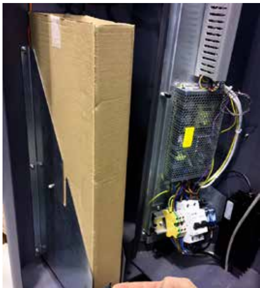
1 – Quand le papier est presque épuisé (ou est épuisé), une alarme est envoyée au logiciel Janica avec une icône dédiée. Contrôler la quantité de tickets par la fenêtre de l'emballage.
