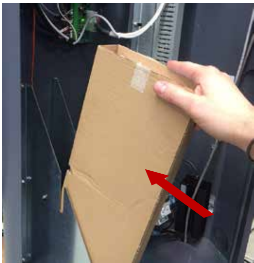
5 – Mettre le nouveau paquet de tickets dans le support prévu à cet effet sur la borne.
