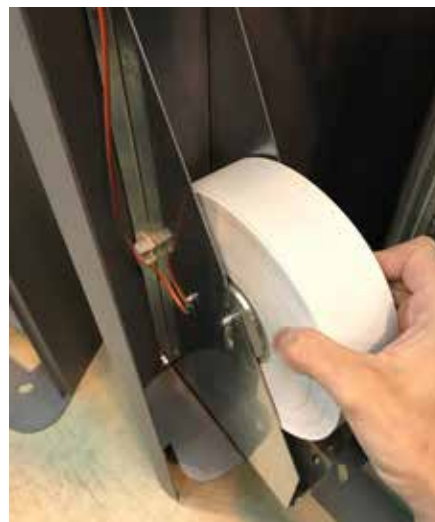
6 – Mettre la nouvelle bobine de tickets dans le support prévu à cet effet sur la borne.
