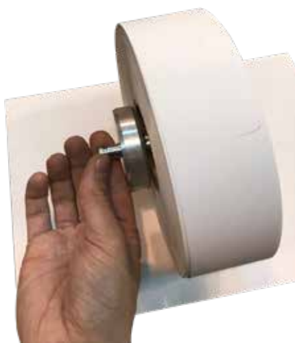
5 – Retirer l'axe et le mandrin de la bobine et les introduire dans la nouvelle bobine de papier.
