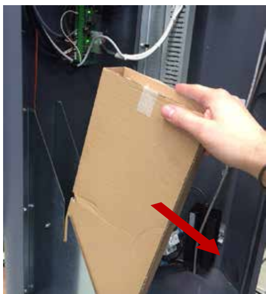
3 – Retirer le paquet de tickets du support de la borne.
