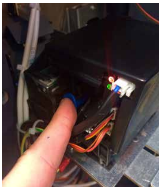
2 – Retirer tous les tickets de l'imprimante en poussant sur le levier latéral bleu montré sur la photo. L'opération correcte est signalée par une DEL rouge sur l'imprimante.
