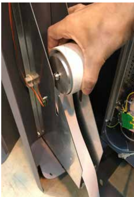
3 – Retirer la bobine de tickets du support de la borne.
