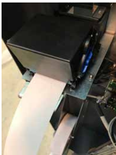
7 – Mettre le ticket avec le côté thermosensible vers le haut en contrôlant que la partie supérieure puisse être imprimée ou marquée par un outil.
