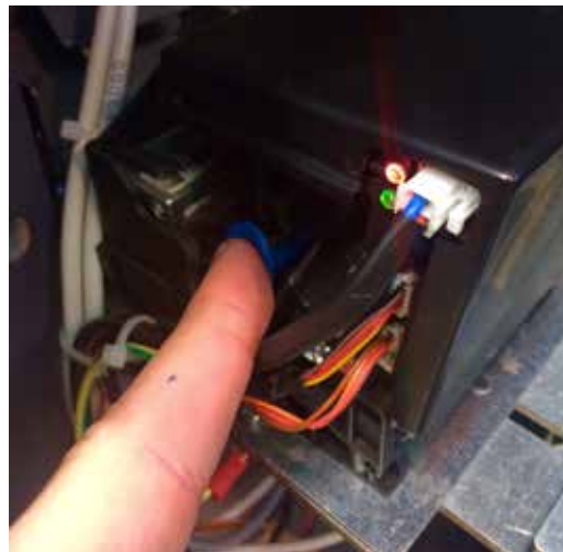
2 – Retirer tous les tickets de l'imprimante en poussant sur le levier latéral bleu montré sur la photo. L'opération correcte est signalée par une DEL rouge sur l'imprimante.
