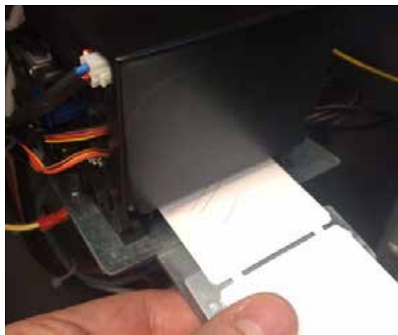
8 – Introduire les tickets dans la fente inférieure de l'imprimante. Le papier sera automatiquement chargé par l'imprimante : 3 tickets seront automatiquement imprimés avec les informations sur le dispositif. Pour contrôler le bon fonctionnement du système, imprimer au moins 3 tickets. Utiliser la fonction « Emit test ticket » (émission du ticket test) sur le menu de la carte Deneb (suivre les instructions du chapitre « MENU DENEb »).
