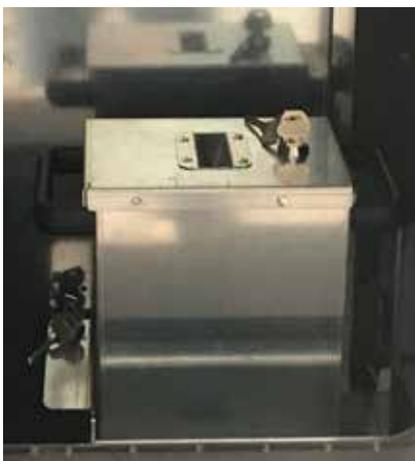
*Incliner et retirer le réservoir*
