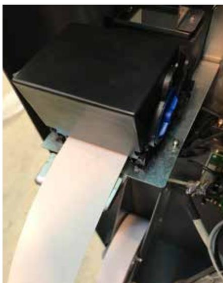
**7** – Mettre le ticket avec le côté thermosensible vers le haut en contrôlant que la partie supérieure puisse être imprimée ou marquée par un outil.
