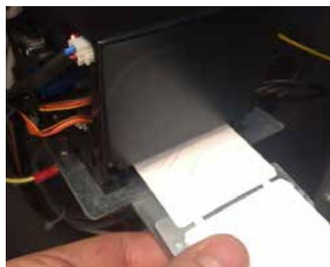
**8** – Introduire les tickets dans la fente inférieure de l'imprimante. Le papier sera automatiquement chargé par l'imprimante : 3 tickets seront automatiquement imprimés avec les informations sur le dispositif. Pour contrôler le bon fonctionnement du système, imprimer au moins 3 tickets. Utiliser la fonction « Emit test ticket » (émission du ticket test) sur le menu de la carte Deneb (suivre les instructions du chapitre « MENU DENEb »).
