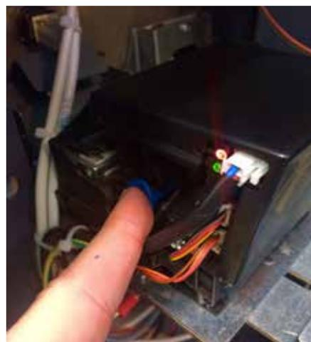
**2** – Retirer tous les tickets de l'imprimante en poussant sur le levier latéral bleu montré sur la photo. L'opération correcte est signalée par une DEL rouge sur l'imprimante.
