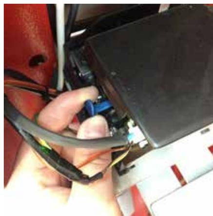
**4** – Remettre le levier bleu de l'imprimante dans sa position d'origine, en le tirant vers l'extérieur avec deux déclics. L'opération correcte est signalée par une DEL verte.
