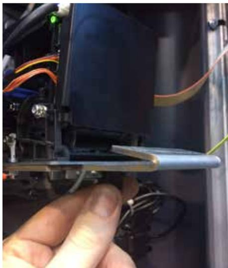
2 – Dévisser la manette de fixation sous l'imprimante, retirer le dispositif du support et le mettre en position pratique pour retirer le ticket bloqué.
