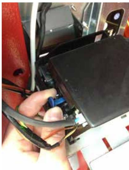
**4** – Remettre le levier bleu de l'imprimante dans sa position d'origine, en le tirant vers l'extérieur avec deux déclics. L'opération correcte est signalée par une DEL verte.
