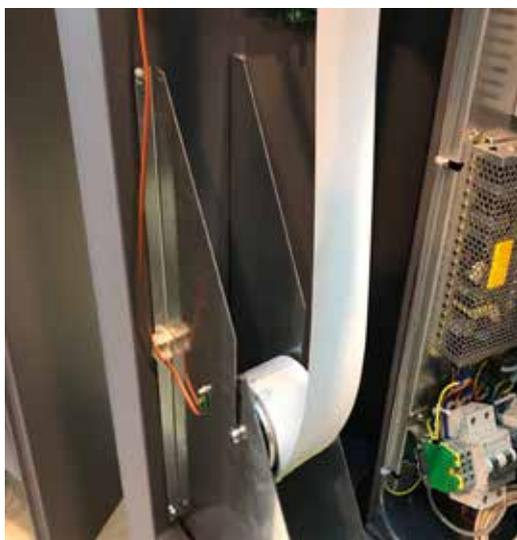
**1** – Quand le papier est presque épuisé (ou est épuisé), une alarme est envoyée au logiciel Janica avec une icône dédiée. Contrôler quoi qu'il en soit la quantité de tickets sur la bobine.
