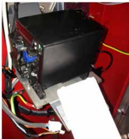
1 – Soulever la tête de l'imprimante en poussant sur le levier bleu, puis retirer le papier de l'arrière de l'imprimante.
