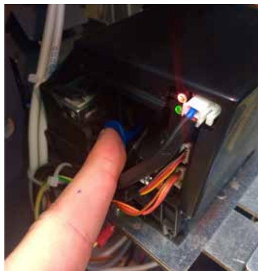
**2** – Retirer tous les tickets de l'imprimante en poussant sur le levier latéral bleu montré sur la photo. L'opération correcte est signalée par une DEL rouge sur l'imprimante.
