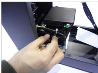
Remettez en place le levier bleu de l'imprimante dans sa position de départ en la tirant vers l'extérieur de deux déclics, l'opération correcte sera indiquée par une led verte éclairée.
