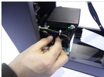
Bringen Sie den blauen Hebel des Druckers wieder in die Ausgangsposition, indem er um zwei Position nach außen gezogen wird; die korrekte Operation wird von einer grünen LED angezeigt.
