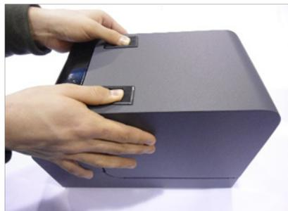
Öffnen Sie die Abdeckung von espas20T, ohne die Stromversorgung zu unterbrechen, indem Sie auf die Hebel an der Abdeckung drücken.
