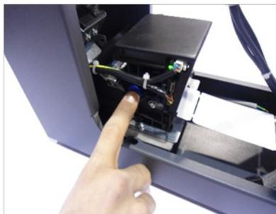
Entfernen Sie eventuelle Tickets aus dem Drucker durch Drücken des auf dem Foto gezeigten blauen Hebels; die korrekte Operation wird von einer aktiven roten LED am Rand des Druckers angezeigt.
