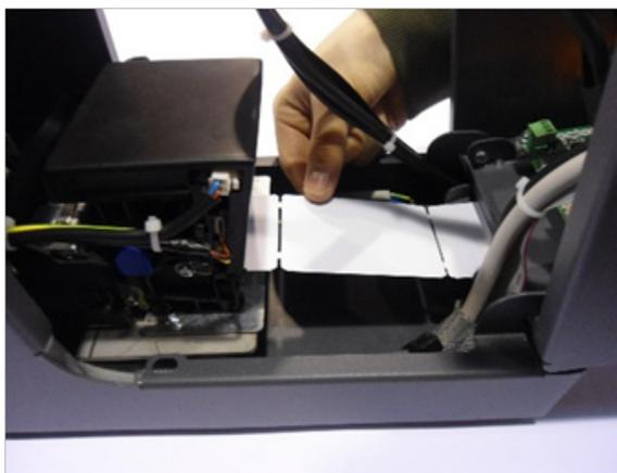
Introducir los tickets por la entrada inferior de la impresora. El papel será arrastrado automáticamente por la impresora para realizar una impresión de prueba.
