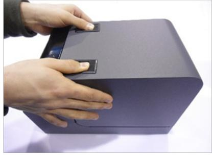
Abrir completamente la tapa de la Espas 20T sin interrumpir la alimentación, empujando las palancas presentes en la tapa.
