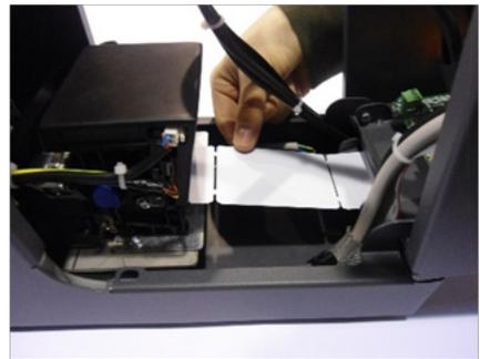
2 - Per una corretta manutenzione è necessario rimuovere la stampante **senza scollegare i cavi di alimentazione e dati**. Svitare il pomello di fissaggio situato al di sotto della stampante, sfilare l'apparecchiatura dal supporto appoggiandola in una posizione comoda per la pulizia.
