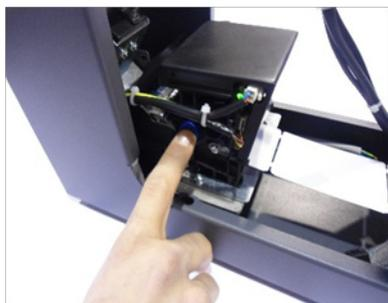
Retirez les tickets éventuels de l'imprimante en appuyant sur le levier latéral bleu indiqué sur la photo; l'opération correcte sera indiquée par une led rouge éclairée à bord de l'imprimante.
