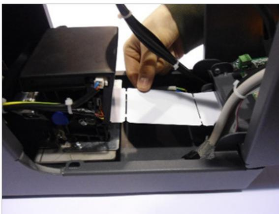
Introduisez les tickets dans l'entrée au bas de l'imprimante Le papier sera entraîné automatiquement par l'imprimante pour un essai d'impression.
