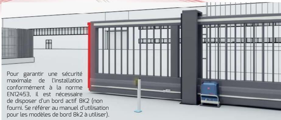
Pour garantir une sécurité maximale de l'installation conformément à la norme EN12453, il est nécessaire de disposer d'un bord actif 8K2 (non fourni). Se référer au manuel d'utilisation pour les modèles de bord 8k2 à utiliser).
