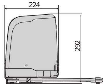
Opérateur électromécanique à bras articulé à usage résidentiel pour la motorisation de vantaux de portails battants jusqu'à 2 m de largeur et d'un poids maximum de 200 kg.
