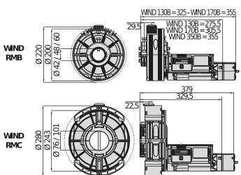
Opérateurs 230 V pour rideaux métalliques fournissant un couple maximum jusqu'à 445 Nm. Adaptés à équipés les rideaux avec poulie de 200, 220, 240 et 280 mm de diamètre et arbre de 42, 48, 60, 76 et 101 mm de diamètre. Existent en versions avec ou sans électrofrein.
