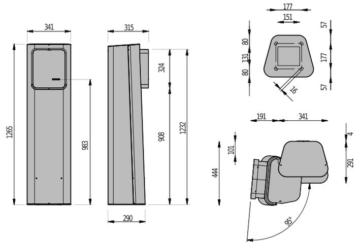
La station Espas 30-U Ultra station est un appareil qui permet de contrôler une barrière de sortie d'un parking.
