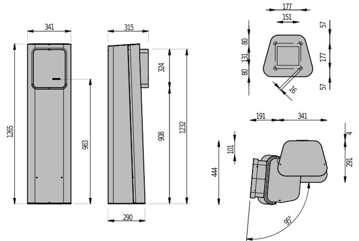
La station Espas 30-I Ultra station est un appareil qui permet de contrôler une barrière d'entrée d'un parking. Elle fait l'interface entre les autres éléments du système au sein d'un réseau câblé. La station assure l'émission rapide de tickets à codes-barres et la gestion des cartes d'abonnement et des opérateurs. Les messages texte et vocaux améliorent l'expérience utilisateur.
