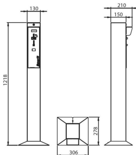
Station d'entrée/de sortie pour systèmes de parking à usage collectif pouvant fonctionner en mode autonome ("stand-alone"). Le dispositif permet de contrôler l'ouverture en entrée ou en sortie. Il peut être relié à des barrières électromécaniques.
