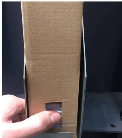
6 - Pour que le capteur de papier fonctionne correctement, poussez les tickets hors de la fenêtre de l'emballage.
