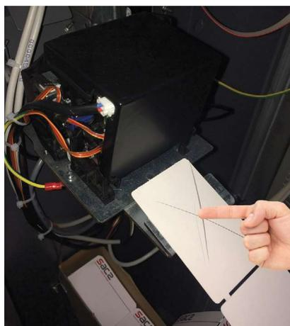
7 - Placez les tickets avec la partie thermosensible vers le haut, en vérifiant avec un outil si on peut écrire sur la partie supérieure .
