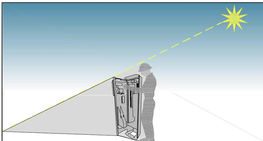
Pour remplacer correctement le paquet de tickets opérez exclusivement en l'absence de lumière solaire directe sur la colonne. Placez-vous à côté de la colonne en couvrant le plus possible les parties internes. Si vous ne suivez pas la procédure indiquée le fonctionnement de l'imprimante risque d'être compromis.
