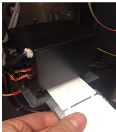
8 - Introduisez les tickets dans l'entrée au bas de l'imprimante. Le papier sera entraîné automatiquement par l'imprimante pour un essai d'impression. Pour vérifier le bon fonctionnement du système imprimez au moins 3 tickets d'entrée du parking; pour activer la fonction d'essai consultez le Par.14 Paramètre DEVICE STATUS
