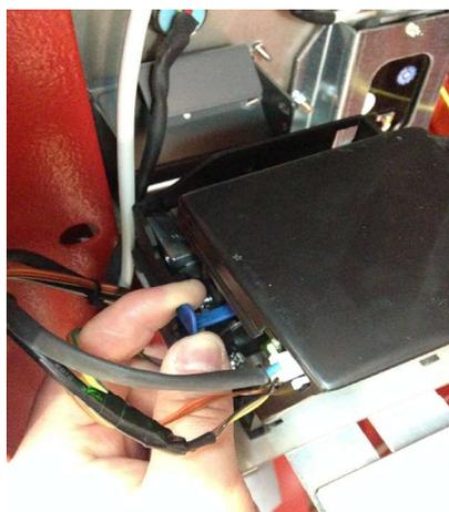
4 - Remettez en place le levier bleu de l'imprimante dans sa position de départ en la tirant vers l'extérieur de deux déclics, l'opération correcte sera indiquée par une led verte éclairée.
