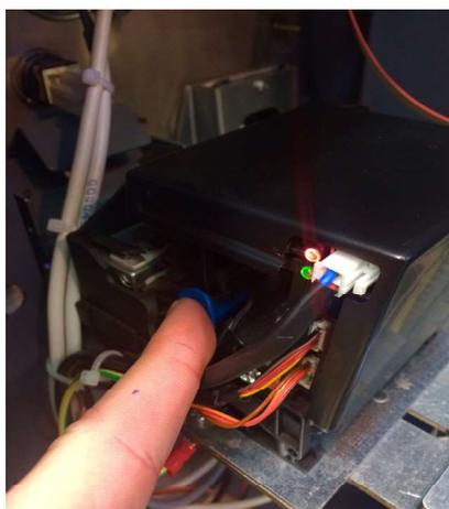
3 - Retirez les éventuels tickets de l'imprimante en appuyant sur le levier latéral bleu indiqué sur la photo p; l'opération correcte sera indiquée par une led rouge éclairée à bord de l'imprimante.
