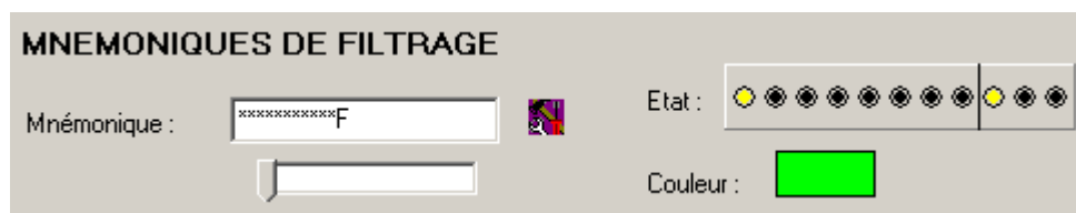
Figure 11 : Les états d'alarme concernés par le traitement validé, sont matérialisés par des voyants allumés Jaunes ou Noirs.
