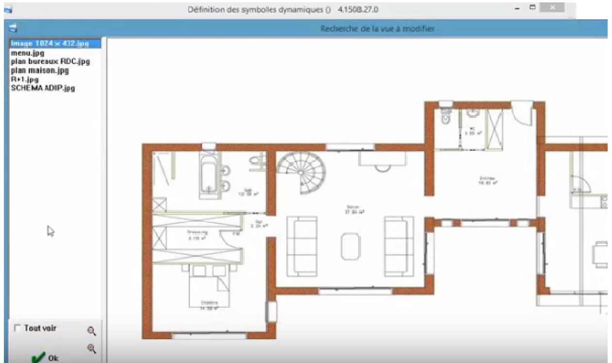
Figure 4 : L'image du plan sélectionné s'affiche, puis effectuer un clic sur Ok pour passer en mode Définition des symboles graphiques
