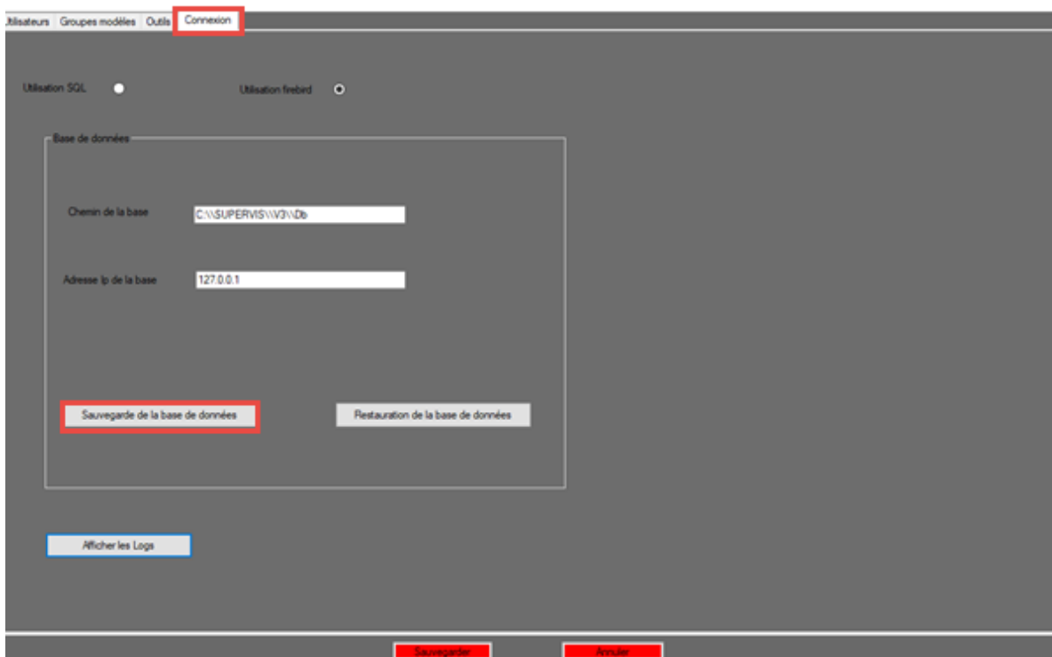
Figure 14 : Par l'onglet [Connexion] est disponible un bouton [Sauvegarde de la base de données] Celui-ci sert à sauvegarder les données Utilisateurs et Groupe modèles configurés dans Adip User. La sauvegarde est à effectuer lors que votre configuration d' Adip User est terminée. La sauvegarde ainsi effectuée est stockée par le chemin suivant : C:\SUPERVIS\V3\Db\Backup
