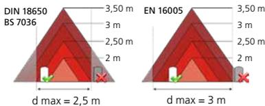
La taille du champ de détection dépend de la hauteur de montage et des réglages du détecteur. Toute la largeur de la porte doit être couverte.
