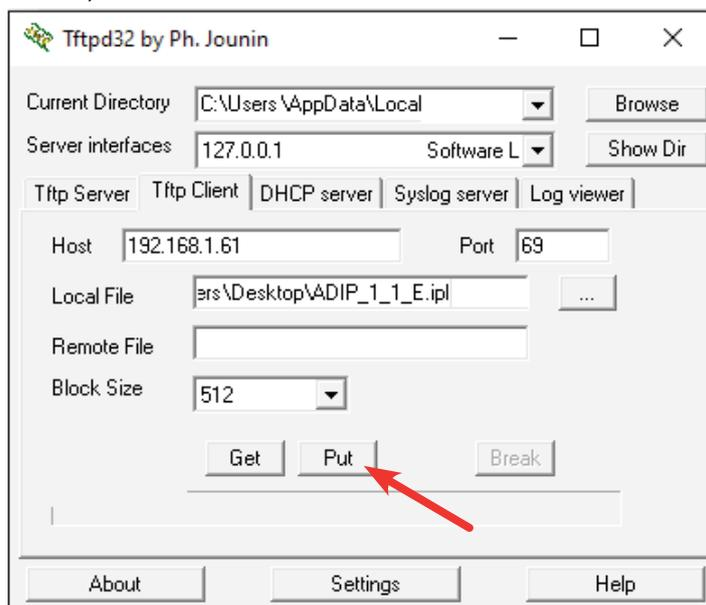
Entrer dans le menu **Effacer / Actualiser firmware (BOOTLOADER)** de l'ADIP et lancer la procédure d'actualisation du firmware. On dispose seulement de **12 secondes** pour cliquer sur **Put** et commencer vraiment le bootloader.
