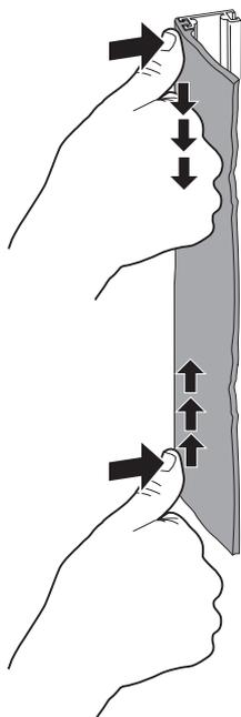
Les ergots en caoutchouc doivent s'insérer complètement dans le profilé porteur en aluminium.
