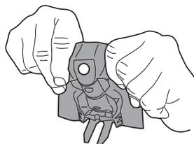
Préparer le capuchon du bas : retirer le plot de drainage.
