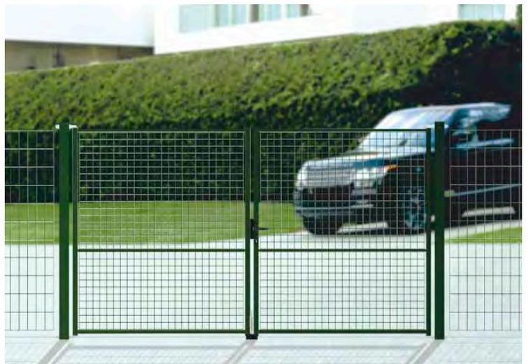
Acier utilisé de type Sendzimir Z275 • Profils fabriqués selon la norme EN 10305 • Tubes galvanisés par procédé Sendzimir selon la norme EN10142 (NFA36321 et NFA49542) • Thermolaquage par plastification haute protection, par poudrage électrostatique au polyester sans TGIC (80 microns minimum) et polymérisation par cuisson au four à 200°C
