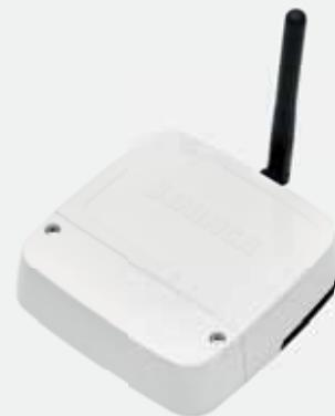
Module émetteur-récepteur 868 MHz pour la commande à distance d'automatismes ou de dispositifs. À installer dans les centrales de commande, dans les systèmes à gérer ou à l'extérieur sur un mur grâce à un couvercle couvre bornes. Équipé de deux entrées avec commande sans tension et de deux sorties relais 250V 5A (charge résistive), il accepte une alimentation de 12 ou 24 Vac/dc. Antenne stylo 868 MHz, longueur 9 cm avec LED RGB pour diagnostic et programmation.
