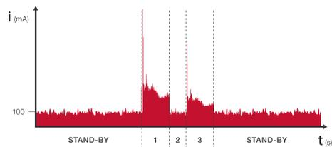
1. MANŒUVRE D'OUVERTURE    2. TCA    3. MANŒUVRE DE FERMETURE
