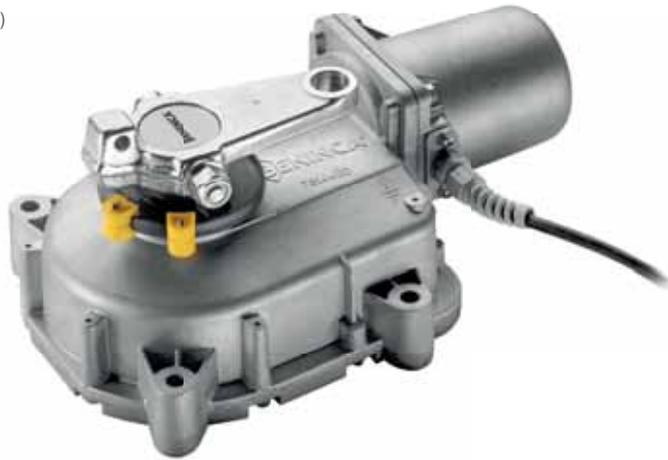
Motoréducteur électromécanique autobloquant disponible dans la version 230 Vac et 24 Vdc, avec possibilité d'ouverture à 180°. Mécanique totalement en métal et butée mécanique incorporée.
