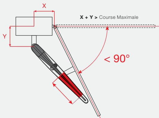
Dans les applications standard, avec ouverture vers l'intérieur, il est conseillé de garder les cotes  $X$  et  $Y$  à peu près égales et de limiter l'écart entre les deux à un maximum de 40 mm **afin d'éviter les grosses variations de vitesse du vantail pendant la manœuvre** :
