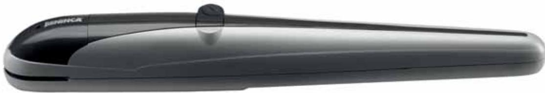
Motoréducteur fiable, silencieux et rapide à installer, grâce aux 2 butées mécaniques réglables en ouverture et fermeture. Disponible dans les versions 230 Vac et 24 Vdc. Vis roulée à section sphérique Ø 20 mm. Déverrouillage par le haut facile d'accès.
