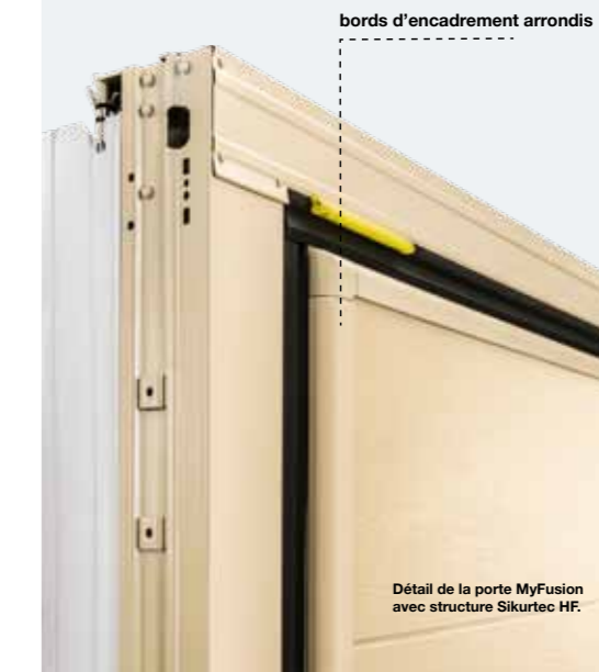
MyFusion Viva 200 Porte basculante MyFusion Viva 200, avec nouveaux bords arrondis, le modèle est caractérisé par l'ajout de rainures horizontales dans les panneaux. Panneau finition extérieure: gauffrée bois ou lisse. À l'extérieur, les panneaux sont traités avec de la peinture super polyester « imitation bois ». Finition intérieure gauffrée stuc, Blanc similaire Ral 9016.
