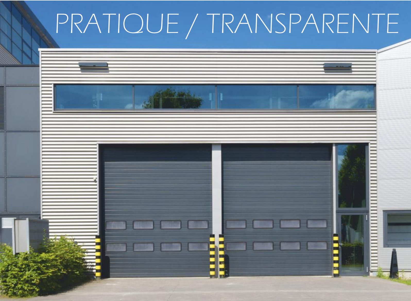
Levant est constituée de panneaux nervurés sandwich double paroi de 40 mm, injectés de mousse polyuréthane sans CFC avec un coefficient d'isolation thermique:  $K=1,4 \text{ W/m}^2\text{k}$ , permettant d'obtenir robustesse et rigidité ainsi qu'une meilleure résistance aux agents atmosphériques. Les joints périmétraux et embouts laqués, permettent de réduire les coûts énergétiques. L'épaisseur de tôle des panneaux est de 0,5 mm avec système anti-pince doigts.
